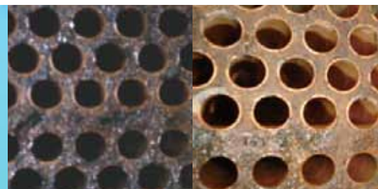
管壁生物膜結構及腐蝕示意圖
